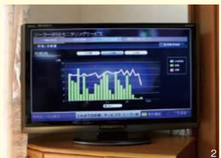
1/リビングの「電力モニター」で、こまめにチェック。2/テレビ画面でも、発電量や売電量などの状況確認ができる。3/発電した直流の電気を家庭用の交流に変換するパワーコンディショナー。
